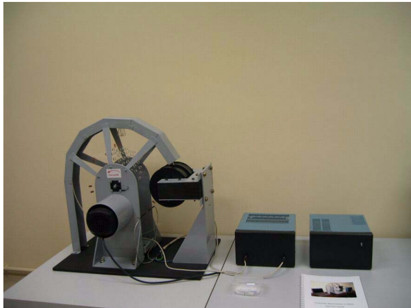
Figuur 2.9. Coercivity spectrometer, J-meter voor het bepalen van magnetische hysteresisparameters van gesteenten.
